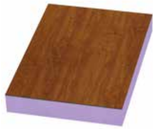
PVC-paneel, glad, met decorfolie aan één zijde 28 mm = 1,01 W/m²K 40 mm = 0,73 W/m²K
