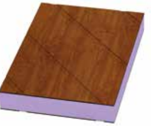
PVC-paneel, eenzijdig voorzien van groeven, met decorfolie aan één of beide zijden 40 mm = 0,74 W/m²K
